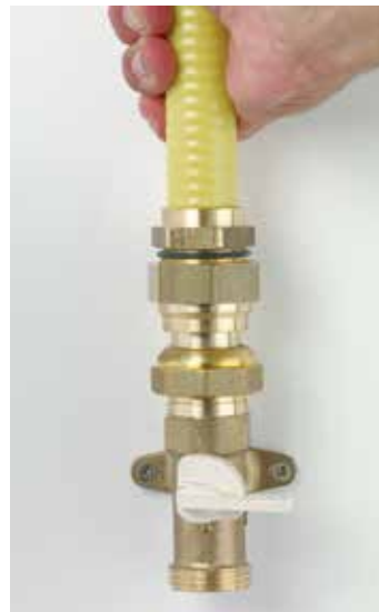
Kontroleer de juiste positie van de buis door een axiale tractie
